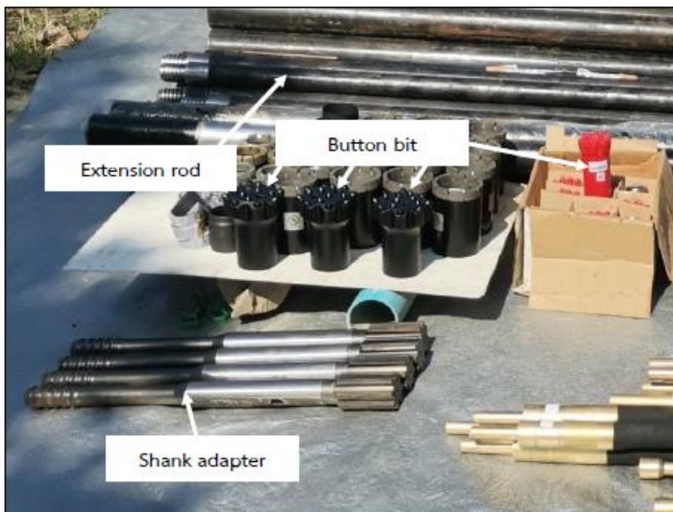
รูปที่ 3-10 แสดงอุปกรณ์การเจาะสำหรับใช้กับเครื่องแบบกระแทก (Percussion drilling)
