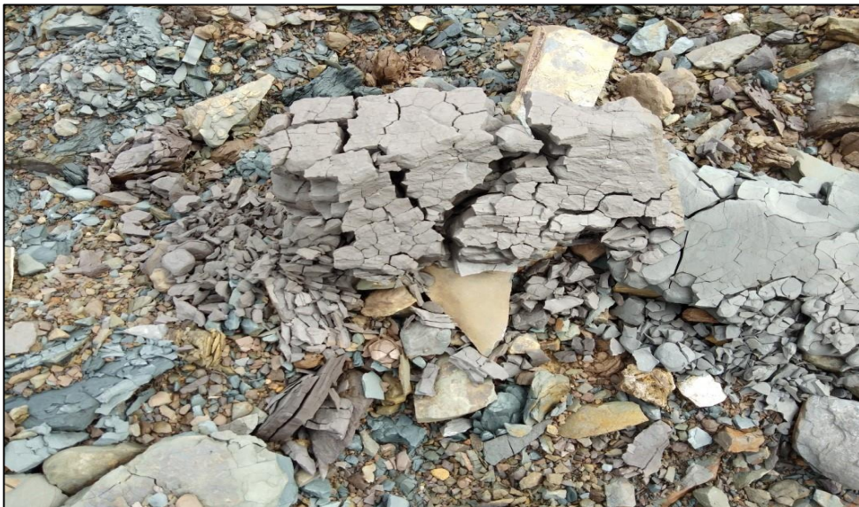
รูปที่ 3-8 แสดงสภาพหินทรายแป้ง (Siltstone) ที่มีการผุพังแตกตัวในสภาพแห้ง (Slaking)
